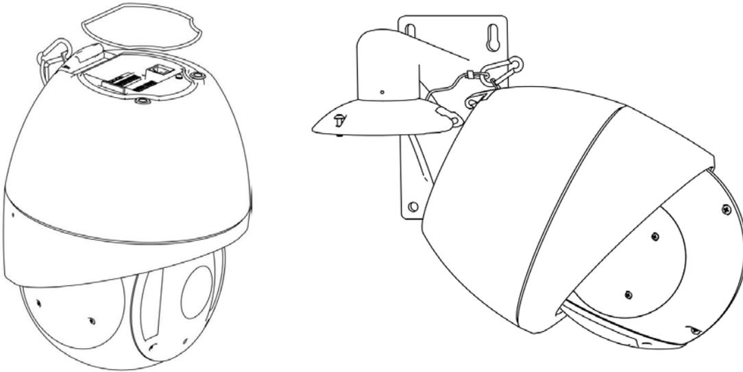
**5. Accrochez le crochet du dôme IR motorisé au caisson arrière puis branchez les câbles aux connecteurs correspondants.**
