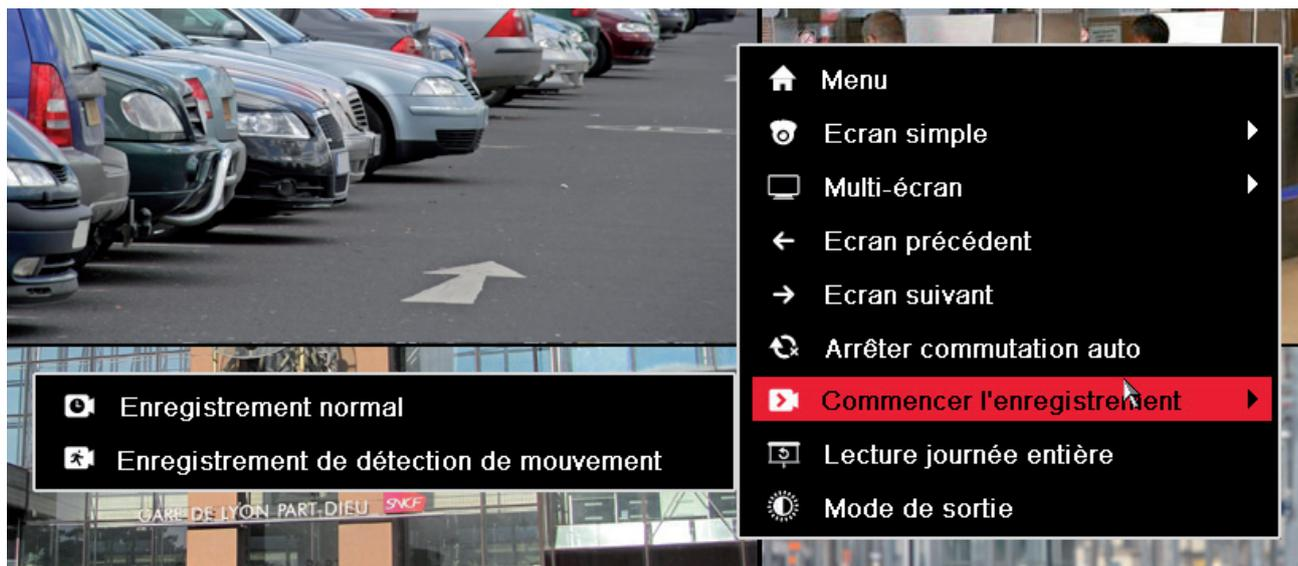
2. Ouvrez le sous-menu de démarrage de l'enregistrement puis sélectionnez le mode d'enregistrement normal ou sur détection de mouvement.
