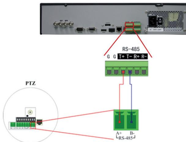
Remarque : Vérifiez que le récepteur du module de balayage panoramique/vertical est connecté aux ports T+ et T- de l'enregistreur.
