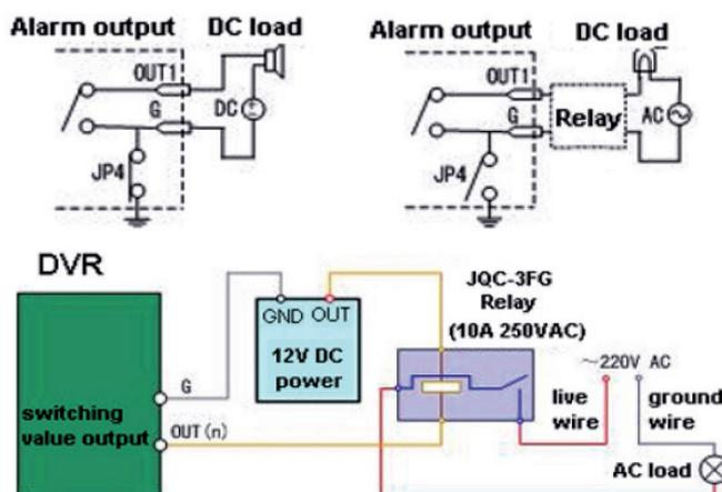
l'interface est branchée sur une charge CA, le cavalier JP4 doit rester ouvert. Utilisez un relais externe pour plus de sécurité (illustration ci-dessus).
