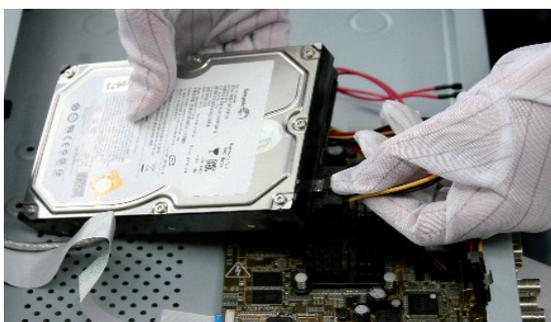
4. Placez le disque dur au bas de l'appareil puis serrez les vis pour le maintenir en place
